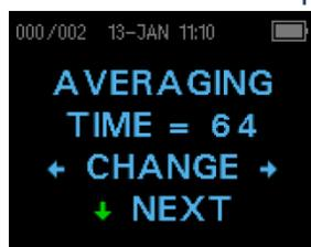
Il tempo medio *massimo* presenta quattro impostazioni disponibili. Il tempo medio stabilisce il tempo massimo di test per ottenere un superamento e influisce sul rapporto segnale/rumore (SNR). Ad esempio, un'impostazione di 32 secondi interrompe il test TE dopo 32 secondi se i criteri di superamento non vengono soddisfatti.
