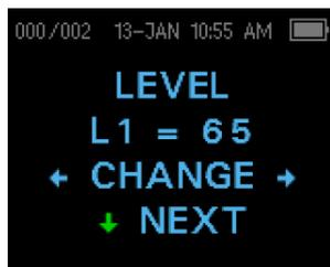
L'intensità dei toni primari (L1, L2) può essere modificata in qualsiasi livello compreso tra 40 dB SPL e 70 dB SPL. Il livello L1 verrà modificato con incrementi di 1 dB premendo i tasti freccia ←SINISTRA o DESTRA→. Premere ↓NEXT (AVANTI) per passare alla schermata L2.
