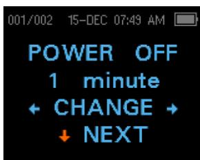
Il menu Power Off (Spegnimento) si riferisce al tempo di spegnimento automatico, che controlla per quanto tempo lo strumento Corti rimane acceso prima dello spegnimento dopo un periodo di inattività. Non occorre spegnere manualmente l'unità Corti. La funzione di spegnimento automatico è progettata per prolungare la durata della batteria dello strumento in caso di inutilizzo. Per impostazione predefinita, lo strumento si spegne in automatico dopo 1 minuto di inattività.
