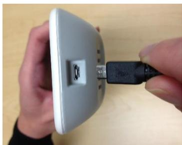
Lo strumento Corti è alimentato da una batteria ricaricabile agli ioni di litio integrata che garantisce 20 ore di funzionamento tra le ricariche complete. L'icona della batteria visualizzata nell'angolo superiore destro del menu principale indica lo stato della batteria. Il simbolo della batteria piena indica una completa ricarica e diventa una batteria vuota a incrementi corrispondenti alla riduzione della ricarica della batteria.
