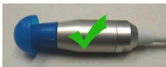
Dopo aver selezionato un auricolare, innestarlo sul tubo della sonda fino a quando non sarà a filo con la base del tubo della sonda. Ruotare leggermente l'auricolare spingendolo sul tubo della sonda. Verificare che l'auricolare sia completamente inserito nella sonda. Non devono essere presenti spazi vuoti tra auricolare e collare della testa della sonda.
