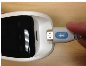
Inserire saldamente il connettore HDMI della sonda nella presa sulla parte superiore dell'unità Corti. La spina prevede una sola direzione di inserimento. Il logo dell'onda GSI si allineerà al pannello di controllo dello strumento.
