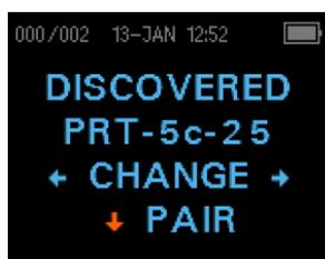
Al termine della ricerca, verranno mostrati tutti i dispositivi rilevati. Una stampante termica compatibile verrà visualizzata come "PRT-NN-NN" (esempio: PRT-5c-25) e altri dispositivi saranno indicati con il loro nome. Usare i pulsanti ←CHANGE→ (MODIFICA) per trovare il dispositivo desiderato e quindi usare il pulsante ↓PAIR (ASSOCIA) per associare l'unità Corti al
