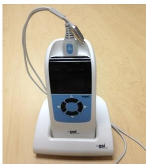
Verificare che il supporto della sonda sia rivolto verso l'estremità del cavo della sonda, all'estremità del logo dell'onda GSI/il connettore HDMI. Spingere delicatamente il cavo della sonda nel relativo supporto nel punto in cui si trova la testa della sonda.
