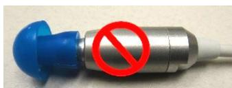
Per rimuovere l'auricolare, afferrarlo delicatamente alla base e ruotarlo durante l'estrazione dall'estremità del tubo della sonda.
