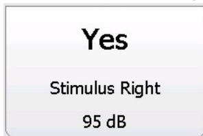
Cada reflejo recogido se muestra bajo los botones de parámetro. Para cada reflejo, el nivel del estímulo y el oído estimulado se muestran si se obtiene un reflejo. Se muestra "NR" (sin respuesta), si no se ha encontrado reflejo en el nivel probado (dB HL). Se muestra "DNT" (no se probó), si no se pudo realizar la prueba.
