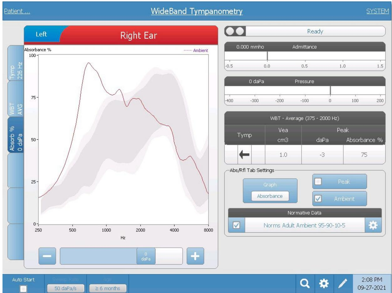
El desplazador en la parte inferior del gráfico ofrece un medio de seleccionar una presión específica y muestra la curva de absorberencia a la presión seleccionada.
