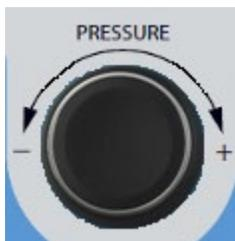
Pressure control (Control de presión) es un control giratorio para el ajuste manual de la presión en el conducto auditivo. Girar el control hacia la izquierda (en sentido contrario a las agujas del reloj), disminuye la presión y girar el control hacia la derecha (en sentido de las agujas del reloj), aumenta la presión. Cuando esté en la pantalla de zoom, el control de presión se utiliza para mover el cursos en la forma de onda.
