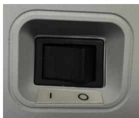
El interruptor de encendido está en el panel derecho. No bloquee el acceso al interruptor.
