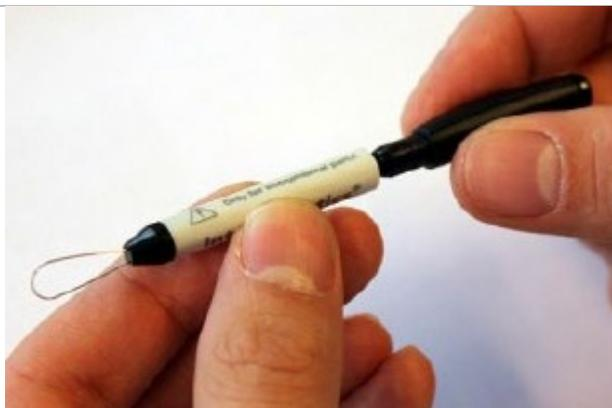
3: Utilice el extremo del alambre para empujar el cerumen desde dentro a afuera en cada uno de los cuatro tubos de la punta de la sonda. No utilice el extremo de cepillo de esta herramienta para limpiar la punta de la sonda; en vez de eso, utilice el hilo de limpieza.
