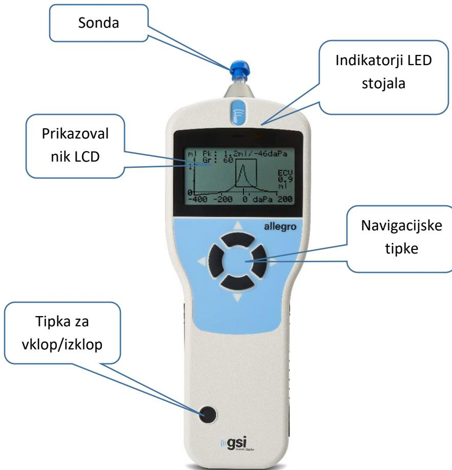
Za vklop naprave GSI Allegro za trenutek pritisnite tipko za vklop/izklop (glejte zgornjo shemo). Ogrevanje ni potrebno, čeprav se bo nekaj sekund izvajala kratka diagnostična rutina. V tem času bo delovala notranja črpalka. Za izklop znova pritisnite in nekaj sekund pridržite tipko vklop/izklop.
