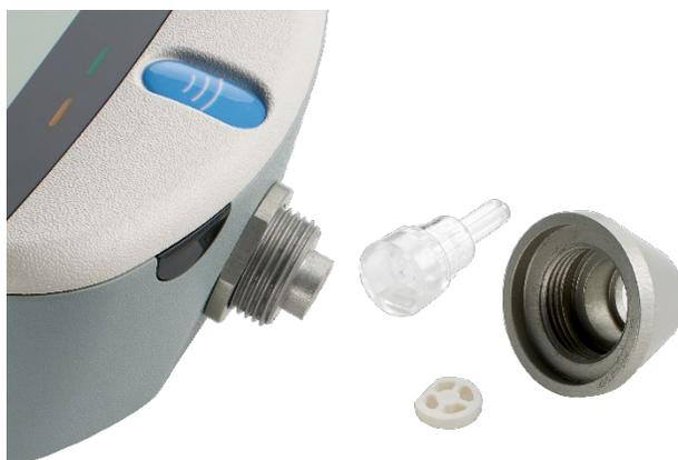
更换探头尖端后，如果发现磨损或怀疑其漏压，则必须更换密封垫。更换探头尖端时请务必正确安装密封垫，使其平面与探头尖端底座的平面对齐。将探头尖端用力套在凸柱上，然后装好鼻锥。请务必将鼻锥旋紧，但是切勿过度拧紧。请勿使用任何工具旋紧鼻锥。
