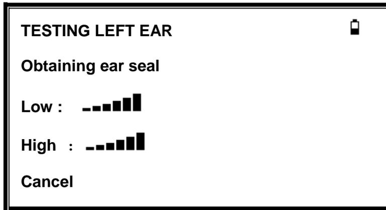
所示的黑格数指示密封的紧密性。应调节耳内的探头，直至“Low”（低）和“High”（高）处至少显示两个黑格。
