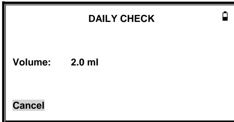
取出探头并用剩余的三个测试腔重复测试。显示屏上应该显示 0.2ml 和 0.5ml 测试腔的容积，容差  $\pm 0.1\text{ml}$ 。5.0ml 测试腔的容积应显示，容差为  $\pm 0.25\text{ml}$ 。完成检查后，按 ◀ 返回主菜单。
