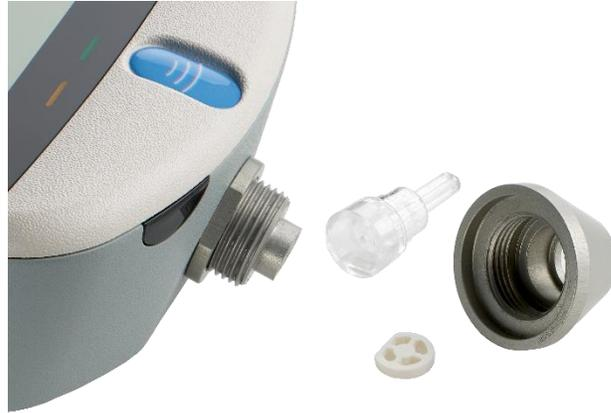
떨링 와서는 프로브 팁을 교체할 때, 마모 징후가 보이거나 압력 누출이 의심되는 경우 교체해야 합니다. 프로브 팁을 교체할 때는 쉘이 프로브 팁의 밀면에서 평평한 쪽과 맞춰져 올바르게 배치되었는지 확인하십시오. 보스 위에서 프로브 팁을 눌러 노즈 콘을 교체하십시오. 노즈 콘을 확실히 고정시키되, 너무 세게 조이지는 마십시오. 노즈 콘을 조일 때 공구를 사용하지 마십시오.
