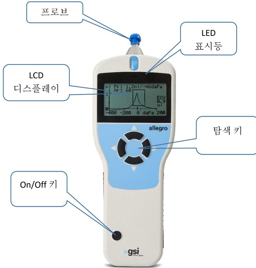
On/Off 키를 짧게 눌러 GSI Allegro 의 전원을 켭니다 (위의 도면 참조). 몇 초 동안 짧은 진단 루틴이 실행되지만 위밍업 시간이 필요하지 않습니다. 이 시간 동안 내부 펌프가 작동합니다. 전원을 끄려면 On/Off 키를 몇 초 동안 다시 길게 누릅니다.
