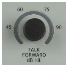
Este controle rotativo permite que o operador ajuste o nível do microfone em um intervalo contínuo de 45 a 90 dB HL ao se comunicar através da Discussão.
