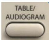
O botão de Status / Audiograma é usado para selecionar o formato para exibição na tela. Pressionando-o alternará a tela entre a exibição da tela de Status (tabela) e da tela de Audiograma para os Tipos de Teste de Tom, Alta Frequência, TEN e Fala. Nos tipos de teste de Tom e Alta Frequência, este botão permite o acesso à opção de Resolução de Frequência Fina para testes de frequência detalhados.
