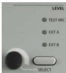
**Controles de Nível de Microfone de Teste, Entrada A e Entrada B** - Para calibrar o sinal de teste para o microfone de teste ou os dispositivos externos, use o botão Selecionar para ativar o LED associado ao dispositivo. Em seguida, use o botão rotativo para ajustar o nível do sinal até que uma indicação média de 0 dB seja obtida no medidor VU do canal selecionado.
