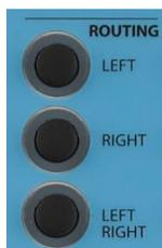
Os botões de Roteamento determinam o roteamento para o estímulo para o transdutor de saída selecionado para o Canal 1 e Canal 2. Esquerda / Direita fornece os estímulos do canal selecionado para os transdutores esquerdo e direito com o sinal combinado. Ambos os limites máximos de dB HL do Canal 1 e do Canal 2 são adequadamente reduzidos dos limites de dB HL máximos não misturados.
