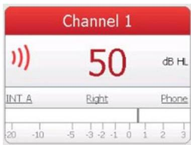
O ícone da onda sonora e o medidor de VU indicam quando um estímulo está sendo apresentado. O ícone de onda sonora e o medidor de VU permanecerão ativos durante a duração do estímulo.
