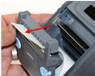
拉动纸卷的末端，将其穿过机盖上的出口槽，关闭机盖。
