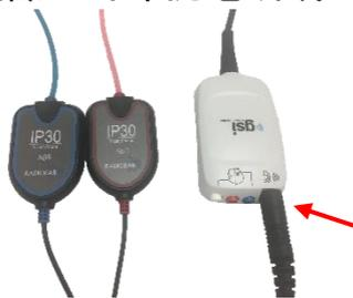
将插入式耳机电线或 OAE 探头末端的插头与前置放大器电线上方印有图标
