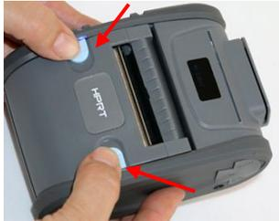
若要将一卷新的标签置入标签打印机中，先同时向内滑动打印机盖顶部的两个蓝色按钮，打开打印机。
