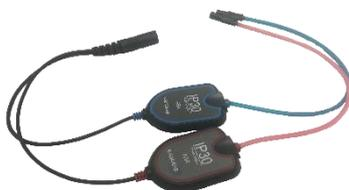
插入式耳机电线与前置放大器盒顶部边缘的插口相连。在使用耳罩进行测试时，将位于红色和蓝色管的末端的插入式耳机耳罩转接器插入耳罩的泡沫边缘。若要使用耳塞，将一次性耳塞安到管末端的透明耳塞转接器上。
