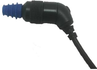
在进行 OAE 筛查时会用到 OAE 耳探头。在 ABR 筛查过程中也可使用这种探头，将其与前置放大器盒相连，传送 ABR 屏蔽信号。在测试过程中，将尺寸适合患者耳朵的一次性耳塞连接到探头尖上。
