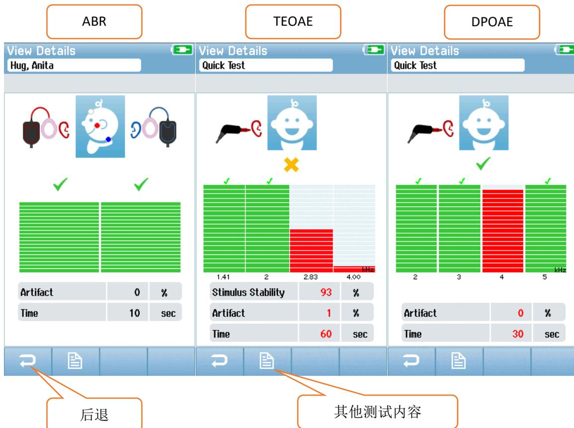
在测试详情屏幕下位于底部的**其他测试内容**，用来查看与测试相关的内容。只有当通过 HearSIM PC 应用程序启用了设备的测试内容选项时，才可以看到这个屏幕。无法在 Novus 上编辑与测试相关的内容。如果需要编辑，必须将测试数据传输至 HearSIM PC 应用程序中，可以在 HearSIM PC 数据库内编辑这些数据。
