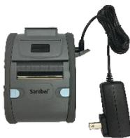
标签打印机由一块锂离子电池供电。若要给电池充电，您必须将充电器的插头插入打印机的 DC 插槽中，然后将电源插入电源插座中。
