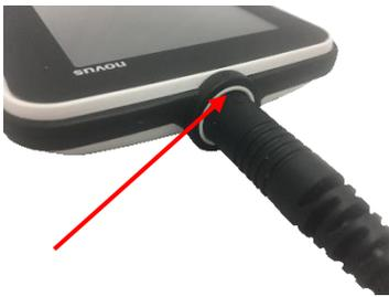
将前置放大器或 OAE 探头（适用于仅有 OAE 的系统）末端的圆点同 Novus 顶部的前置放大器连接器插槽上的圆点对齐。插入插头，将其推入正确位置，确保连接牢固。
