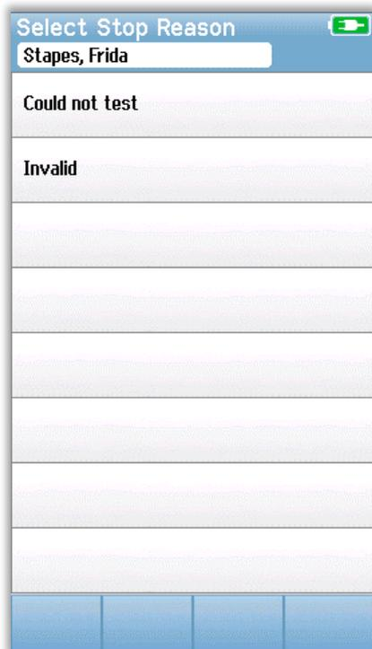
管理员可使用 Novus PC 应用程序 HearSIM 配置您的 Novus，要求在手动停止测试时输入停止原因。这条停止原因信息将被保存在测试记录中。
