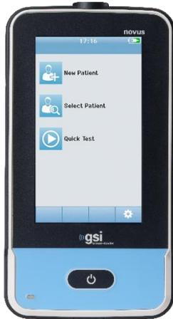
Novus 的显示器是电阻式触摸屏。这个触摸屏会对触碰图标时产生的压力作出相应。使用手指或触屏笔便可产生这种压力。应多加小心，不要划伤触摸屏的表面。
