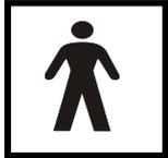
**定义：** BF 型应用部分： IEC 60601-1 使用应用部分这个术语来描述医疗设备中必须与患者有身体接触才可使设备有预期功能的部分。当设备与患者有导电接触或有短期或长期接触时，会用到 BF 型。 BF 型是一种能提供高水平的电击防护的应用部分，要比 B 型应用部分提供的防护水平高，尤其是针对可允许的患者泄漏电流和患者辅助电流。 GSI Novus 是一部符合国际标准 IEC60601-1 的 BF 型设备。应用部分包括耳塞、耳罩和电极。
