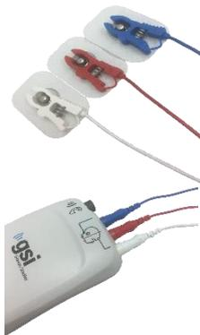
将白色、红色和蓝色的带夹子的电极引线同按扣式电极相连。将电极线插口端连接到前置放大器上，与前置放大器上的颜色相对应。
