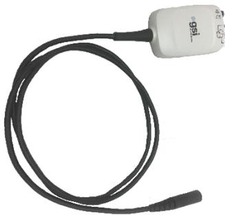
前置放大器电线连接到 Novus 的顶部。将电极引线和声换能器与前置放大器盒顶部的插口相连，进行 ABR 筛查。
