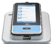
Coloque o Novus na base de acoplamento para que ele se encaixe nas guias de colocação em forma de U. A colocação adequada na base de acoplamento é necessária para garantir o carregamento da bateria. Ímanes na base do acoplamento e o dispositivo formam uma conexão para reduzir a chance de que o Novus caia da base. A bateria começa a carregar automaticamente quando o Novus é colocado corretamente no suporte alimentado pela corrente alternada.
