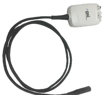
O cabo do pré-amplificador se conecta ao topo do Novus. Os fios do eléctrodo e o transdutor acústico se conectam às tomadas na parte superior da caixa do pré-amplificador para realizar exames ABR.
