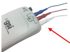
Conecte os três fios do eléctrodo com segurança nos conectores de eléctrodos no topo do pré-amplificador, combinando a cor do fio condutor com a tomada. Certifique-se de que eles estão totalmente inseridos na ficha.
