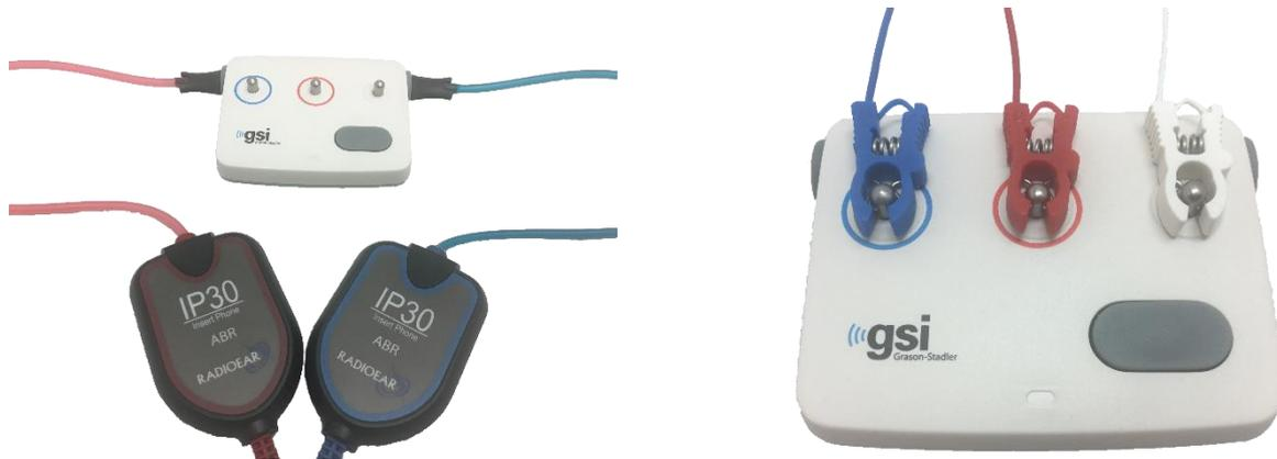
1. Verifique se os fios do eletrodo e os fones de ouvido estão conectados ao cabo do pré-amplificador Novus e se o cabo do pré-amplificador está ligado ao Novus.
