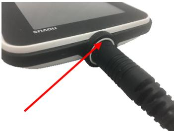
Alinhe o ponto no final do cabo do pré-amplificador ou da Sonda OAE (somente para sistemas OAE) com o ponto na tomada do conector do pré-amplificador na parte superior do Novus. Insira a ficha e empurre-a firmemente no lugar.
