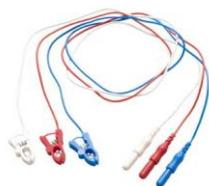
Os fios condutores do eléctrodo são fornecidos com a compra do sistema quando a ABR estiver incluída. Os plugues coloridos codificados se conectam às tomadas na parte superior da caixa do pré-amplificador. Os fios conectores do eléctrodo são ligados aos eléctrodos descartáveis.
