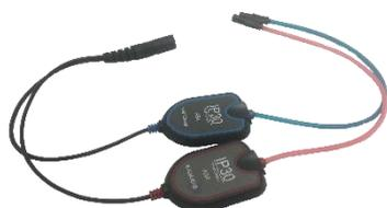
O cabo do fone de ouvido é inserido no conector na borda superior da caixa do pré-amplificador. Para testar o usando os acopladores de ouvido, os adaptadores dos acopladores do ouvido no final dos tubos vermelho e azul são inseridos na borda de espuma dos EarCups. Se forem usadas fundas, as fundas descartáveis são anexadas aos adaptadores de orelha no final dos tubos.
