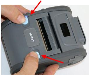
Para inserir um novo rolo de etiqueta na impressora de etiquetas, abra a impressora deslizando os dois botões azuis na parte superior da tampa da impressora para dentro.
