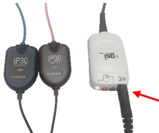
Alinhe a ficha no final do cabo do fone de ouvido ou da sonda OAE com o soquete na parte superior do cabo do pré-amplificador marcado com o gráfico
