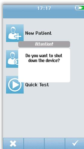
Para apagar el dispositivo, presione el botón de *inicio* desde la pantalla principal. Aparecerá un cuadro de diálogo de confirmación y, luego, seleccione la **marca de verificación** para confirmar o **X** para cancelar. Alternativamente, para apagar el Novus de manera manual, mantenga presionado el botón de *inicio* durante más de 5 segundos.
