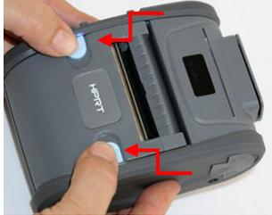
Para insertar un nuevo rollo de etiquetas en la impresora de etiquetas, abra la impresora deslizando hacia adentro los dos botones azules que se encuentran en la parte superior de la tapa de la impresora.
