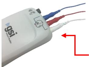
Conecte los tres cables de electrodos de forma segura en los enchufes hembra para electrodos en la parte superior del preamplificador, haciendo coincidir el color de cada cable con el color del enchufe hembra. Asegúrese de que estén completamente insertados en el enchufe hembra.
