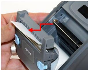
Pase el extremo del papel a través de la ranura de salida del papel en la cubierta y cierre la cubierta.
