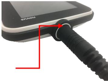
Alinee el punto al final del cable del preamplificador o de la sonda para OAE (solo para sistemas de OAE) con el punto en la toma del conector del preamplificador en la parte superior del Novus. Inserte el enchufe y empújelo hasta que quede fijo en su lugar.
