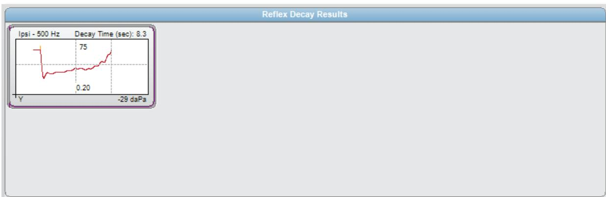
A seção de resultados de declínio de Reflexo exibe os testes de declínio de Reflexo armazenados. As informações do bloco de notas de dados de coleta são selecionadas e armazenadas (ao selecionar o ícone armazenar da barra de menu Declínio de Reflexo). Linhas verticais indicam os pontos de 5 e 10 segundos no eixo de tempo (x). Uma linha horizontal indica o valor de amplitude de 50% da resposta.
