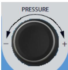
O Controle de Pressão é um controle giratório para ajuste manual da pressão dentro do canal do ouvido. Girar o controle para a esquerda (sentido anti-horário) reduz a pressão e girar o controle para a direita (sentido horário) aumenta a pressão. Quando na tela de zoom, o Controle de Pressão é usado para mover o cursor na forma de onda.
