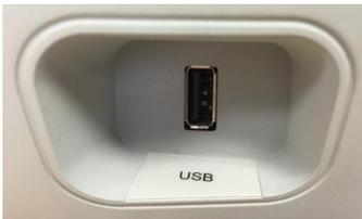
Um plugue USB (A) também é encontrado no painel direito. A conexão USB pode ser usada para conectar uma impressora ou um drive USB para upgrades.
