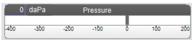
O medidor de pressão exibe a pressão em tempo real à medida que está sendo gravada da sonda no canal do ouvido. As unidades são decapascals (daPa). O valor atual é exibido no topo esquerdo do medidor.
