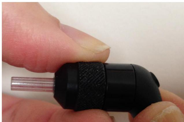
2: Remova a Ponta de Sonda. Note a gaxeta dentro da ponta.
