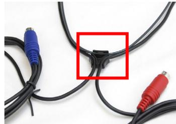
5. Girare la clip e collocare i fili del microfono della sonda nella clip.
