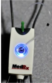
⚠ Per il controllo delle infezioni e l'affidabilità dei risultati, MedRx consiglia di utilizzare un nuovo tubo della sonda con ciascun paziente. **Per eseguire misurazioni precise, calibrare il tubo della sonda dopo ciascuna sostituzione.**
