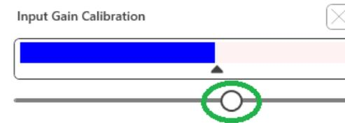
8. Ao utilizar a opção "Mic" (Microfone), ajuste a sua entrada usando o controlo deslizante para que ele atinja o triângulo preto sob o medidor VU.
