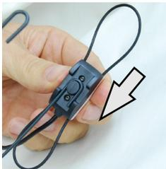
2. Instale el gancho en la parte trasera del micrófono sonda. Tire del gancho hacia abajo para que se asiente en el poste.
