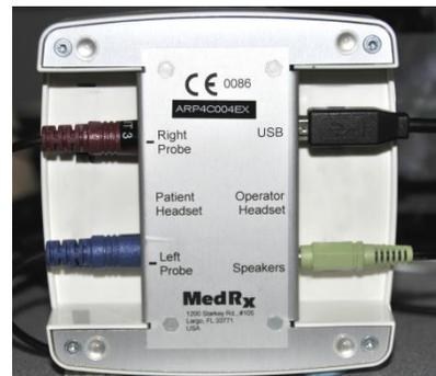
2. Conecte os microfones sonda à unidade principal do AVANT REM Speech+ como demonstrado acima. NÃO force o conector contra os plugues. Alinhe corretamente antes da inserção. Um cabo do plugue do "Alto-falante" no REM Speech+ será conectado ao plugue de entrada do alto-falante alimentado, fornecido com a sua unidade.
