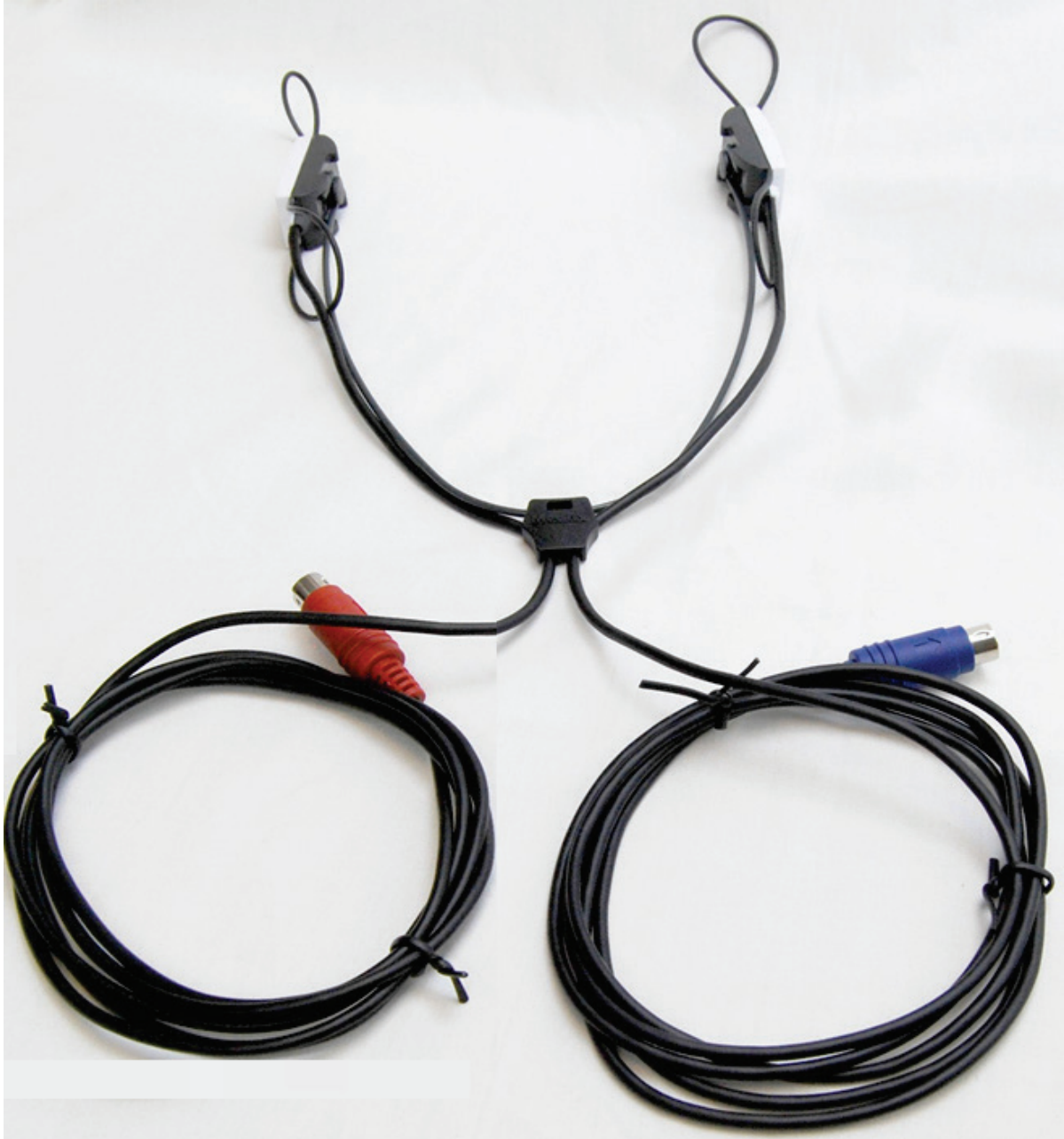
Instalación completa de la percha de los Micrófonos de Sonda.
