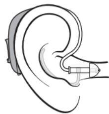
Empurre suavemente o adaptador no seu canal auditivo até que o tubo fino fique perto da sua cabeça. Se o tubo fino tiver uma alça, coloque-a na orelha para que siga o contorno da orelha.
