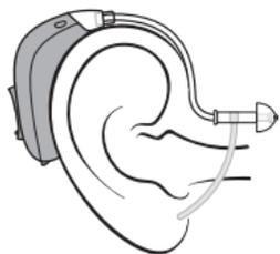
Coloque o aparelho auditivo atrás da sua orelha. O tubo fino sempre deve ser usado com um adaptador acoplado. Use apenas peças desenvolvidas para o seu aparelho auditivo.
