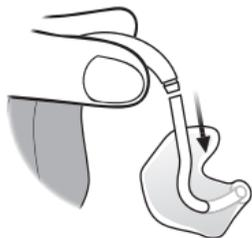
Déconnectez le tube et l'embout du coude. Tenez le coude fermement lorsque vous le détachez le tube. Sinon, l'aide auditive pourrait être endommagée.
