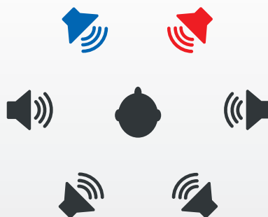
Figure 3. Configuration du test avec un total de six haut-parleurs. Il y a deux locuteurs cibles à l'avant (en bleu et rouge, à +/- 22 degrés). Chacun des quatre haut-parleurs restants (en noir, à +/- 90 degrés et +/- 150 degrés) présente un brouhaha à quatre locuteurs, ce qui produit un brouhaha à 16 locuteurs. Tous les haut-parleurs sont placés à 141 cm du participant.
