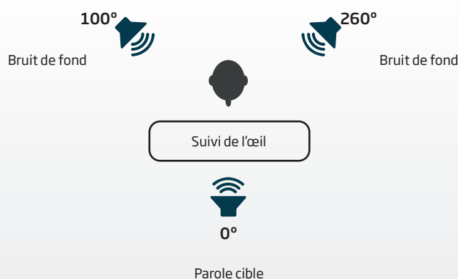
Figure 1 : La configuration du test pour les mesures du rapport signal/bruit en sortie et les mesures de pupillométrie avec un locuteur cible provenant de l'avant et des locuteurs de masquage. On notera que le dispositif de suivi de l'œil n'est utilisé que pour les mesures de pupillométrie. Les signaux de fond présentaient chacun des combinaisons alliant un seul locuteur interférant et du bruit ressemblant à des paroles.
